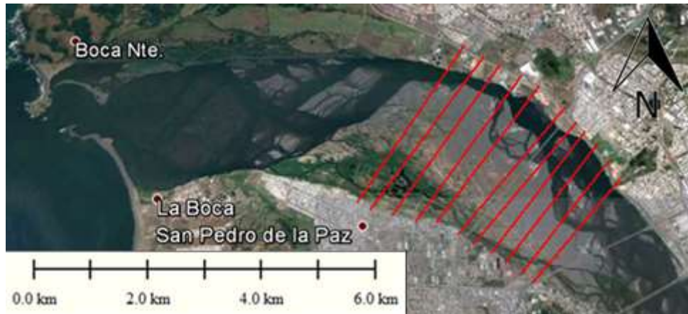
Figura 5: Perfiles transversales en el río Biobío.
